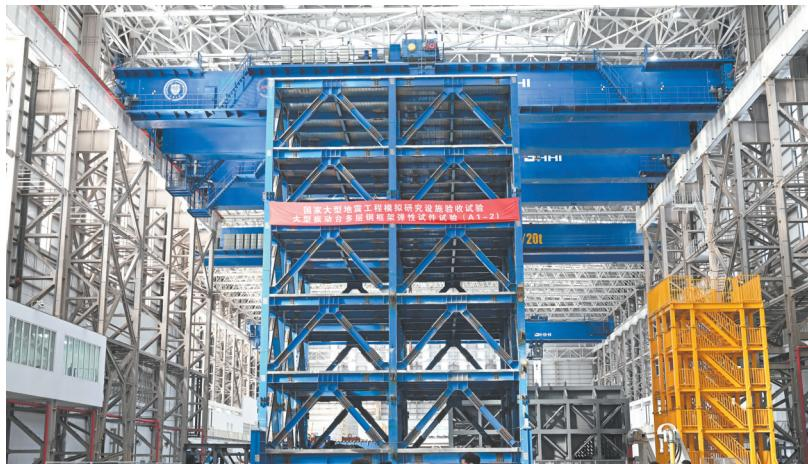
11月5日,“大型地震工程模拟研究设施”项目正在进行验收试验。
