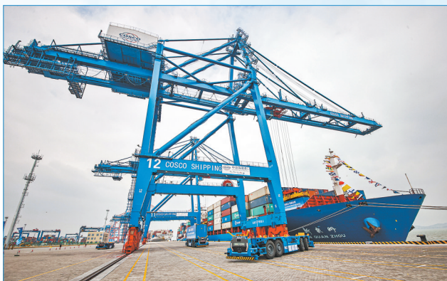
依托覆盖码头的5G信号,无人集卡在完成集装箱吊装作业。(资料图)
