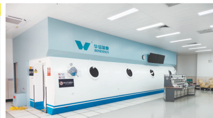
高压氧舱被称为“生命方舟”,舱体是一个密闭圆筒。
