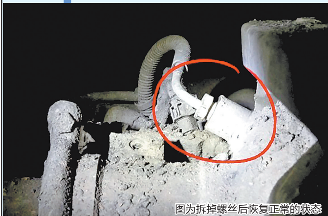
图为大货车尿素喷射系统的后处理器上被加装螺丝的状态
