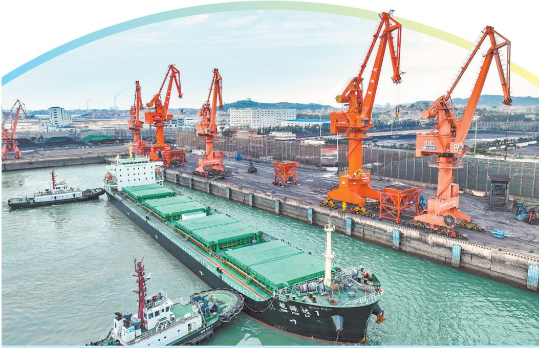
近日,在经历了一个多月的调试试与试运行,泉州港务集团有限公司肖厝港区新增的3台新门机全部顺利交机使用。据悉,该机型为多用途门座起重机,在技术和功能上均有改善。新门机投入使用后,日装卸效率可达4万吨,有效提升了肖厝作业区3#和4#泊位的装卸效率,加快了码头货物吞吐周转运输。(林劲峰 陈淑华 庄松鹏 摄)
