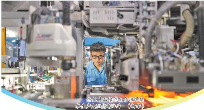
企业员工操作全自动焊接机生产太阳能电池片 (新华社)
