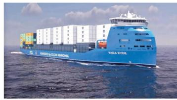
日前,由中国自主研发设计的1400TEU无舱盖集装箱船获得来自比利时船东CMB.TECH的订单。该型船是全球首艘氨燃料动力集装箱船,其成功签约标志着全球航运业在清洁能源领域又取得了重要突破,旨在共同应对全球气候变化和环境保护的挑战,对引领航运业可持续发展具有里程碑意义。该船属于欧洲支线船型,主要服务于挪威—德国航线,总长约150米,型宽约27米,可装载约1400个20英尺标准集装箱,配备氨燃料发动机、氨燃料罐、供给系统和加注系统。(央视)
