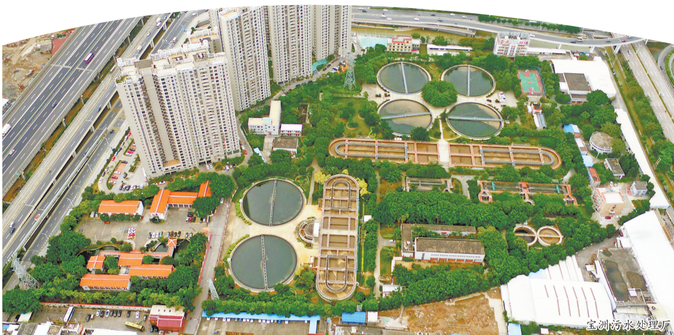
改造33条现有管网,实施7个小区及周边的雨污分流改造,新建管网130公里等;东海污水厂片区项目,主要是完善7条市政道路管网、有效修复东海、宝洲片区的市政道路管网病害缺陷、完善污水“毛细血管”、落实截污系统限流和防倒灌措施,并有效解决江南和万安、双阳的污水收集处理问题,提升中心市区污水收集率和进水BOD浓度。
