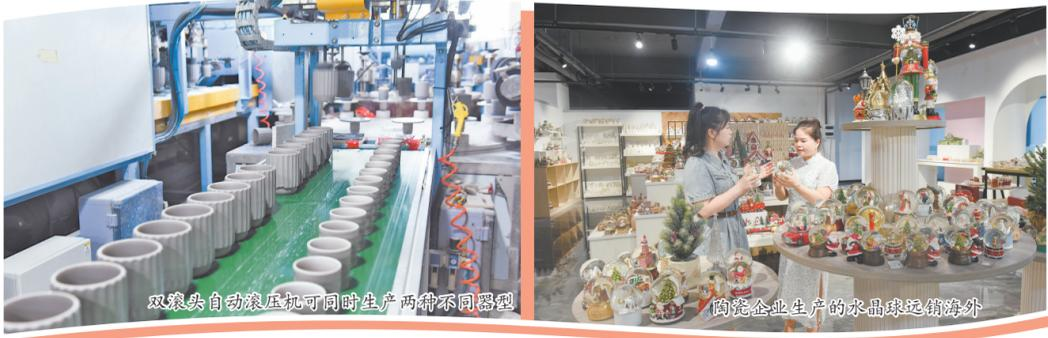
双滚头自动滚压机可同时生产两种不同器型
