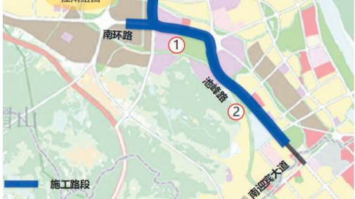
三、占道情况 ①南环路:围挡占用机动车道空间,施工期间主线保留双向四车道机动车通行空间,非机动车与行人共板通行; ②池峰路:围挡占用主线六个机动车道,施工期间主线通过硬化边分带保留双向四个机动车道通行空间,非机动车与行人共板通行。
