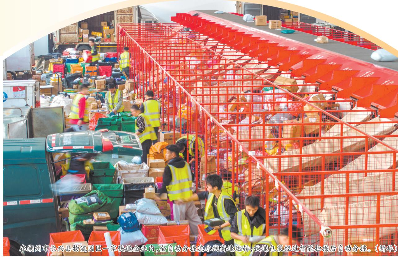
在沈阳市沈北新区一家快递企业内，全自动分拣流水线高速运转，快递包裹经过智能扫描后自动分拣。(新华社)
