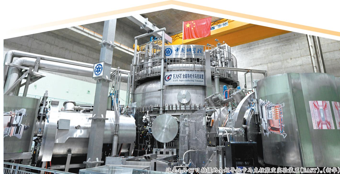
这是1月15日拍摄的全超导托卡马克核聚变实验装置(EAST)。(新华社)
