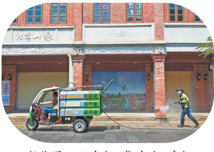
新能源环卫车辆,集冲洗、清扫、吸尘等多功能于一体。(李莹 摄)
