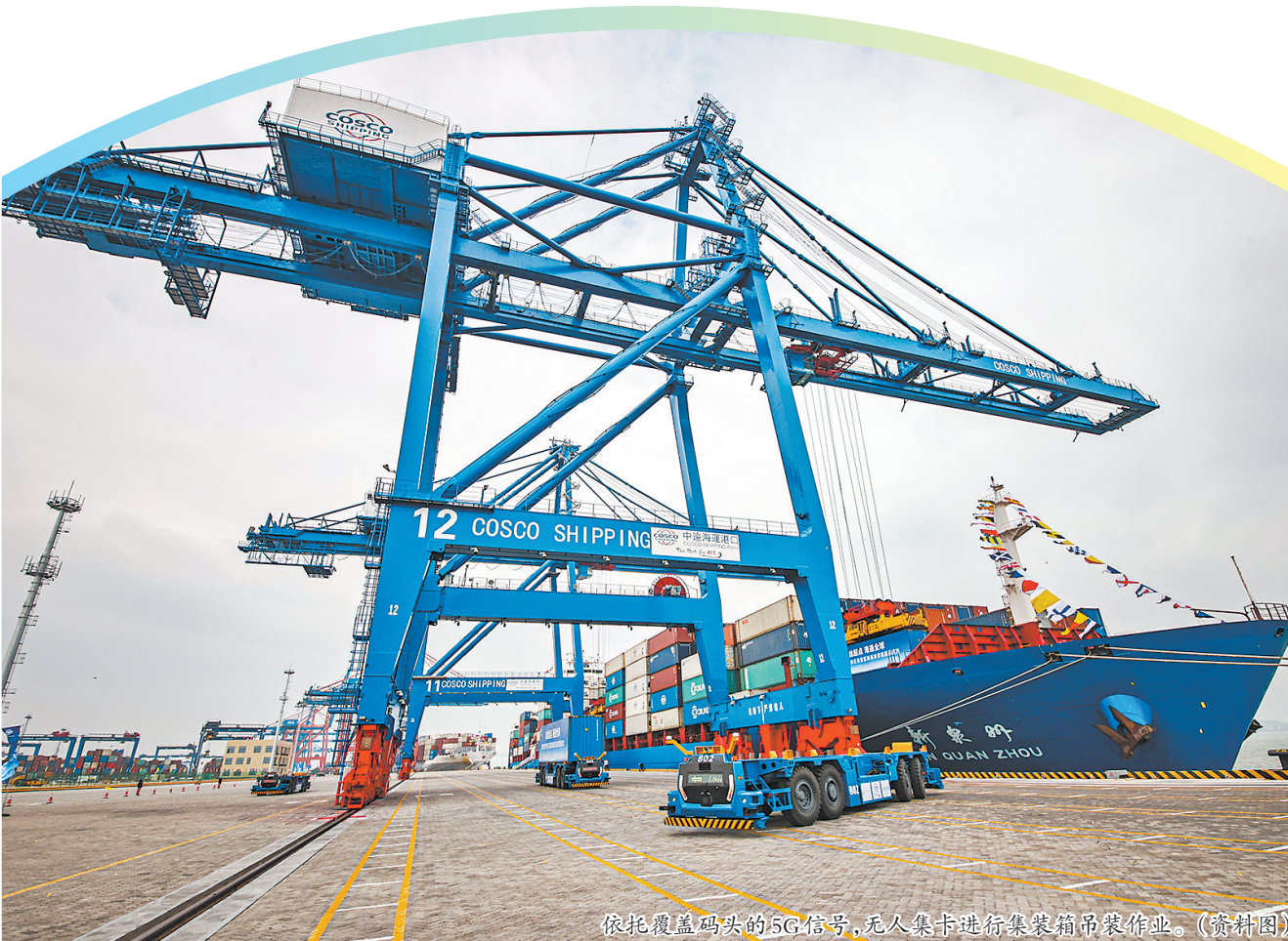
依托覆盖码头的5G信号,无人集卡进行集装箱吊装作业。(资料图)
