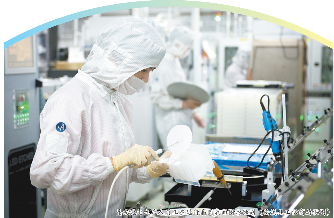
品安施电生产人员正在进行晶圆表面图形蚀刻（安溪县工信局供图）
