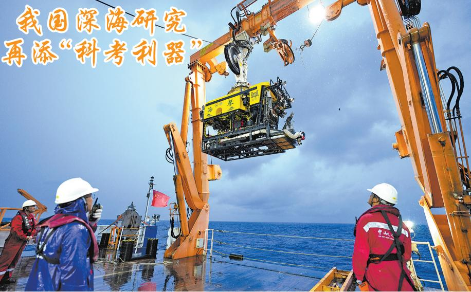
8月23日清晨，在南海的晨曦中，我国自主研制的6000米级深海无人遥控潜水器(ROV)“海琴”号，经过8个小时作业，从4140米深海凯旋，成功进行海试，我国深海研究又多了一个“科考利器”。
