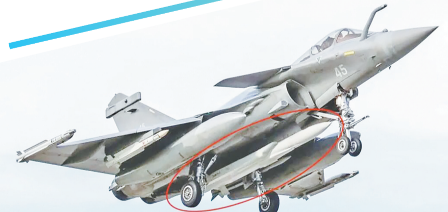
法国“阵风M”战斗机机腹下挂载新型超声速核导弹ASMPA-R(图中红圈内)(郭芳)
