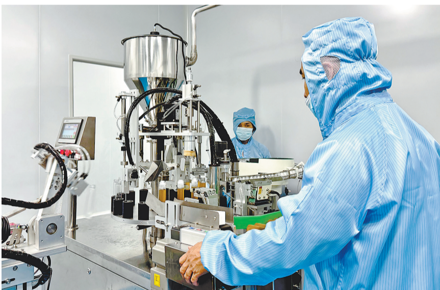
灌装车间里,洁净的玻璃瓶与水蜜头包装在传送带上匀速移动,自动化完成灌装、旋盖、封装等一系列工序。
