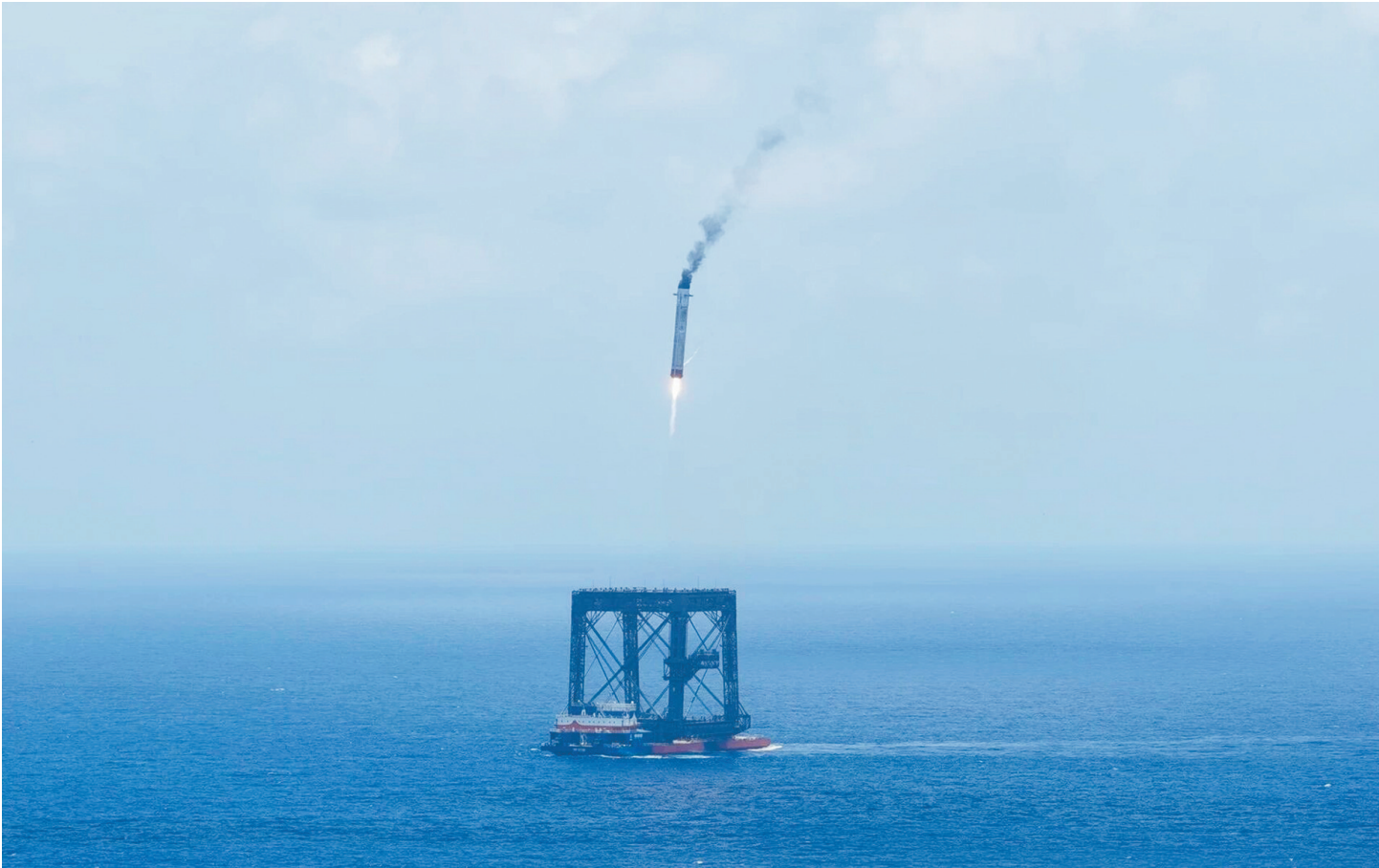
2026年7月10日,长征十号乙运载火箭在海南商业航天发射场发射升空,成功将卫星送入预定轨道,火箭一子级成功回收,任务取得圆满成功。这是海上回收平台通过网系捕获方式成功回收长征十号乙运载火箭一子级(无人机照片)。(新华)
