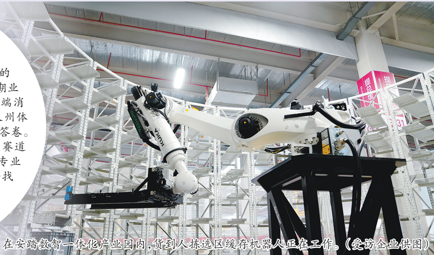
在安踏数智一体化产业园内,货到人拣选区缓存机器人正在工作。(受访企业供图)
