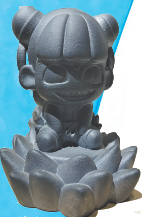
用铸造3D打印设备制作的哪吨铸件 (陈玲 摄)
